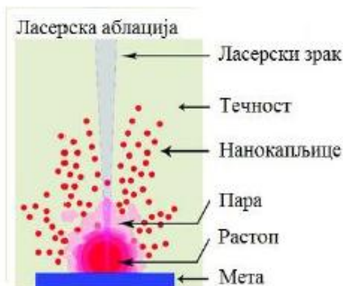
Слика 3.5 Ласерска аблација [2].
