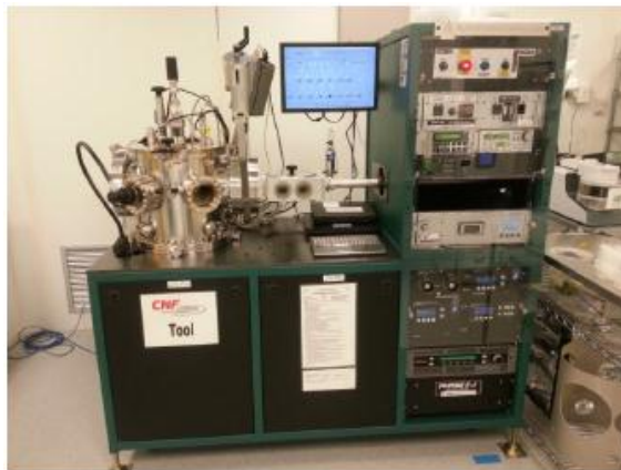
Слика 3.4 Уређај за распршивање методом плазме [2].
