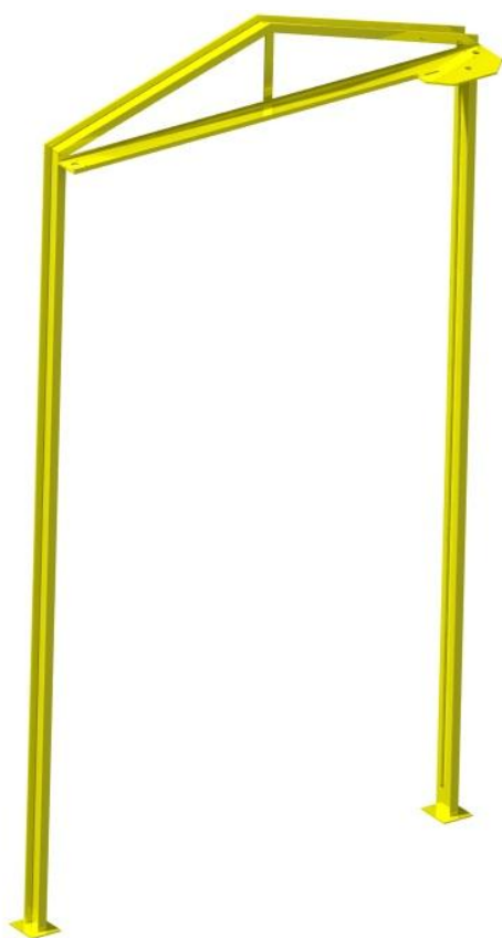
слика 3.12 – носећа конструкција
