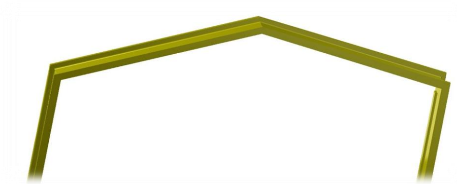
слика 3.15 – заварена конструкција врха носача профила UNP 16
