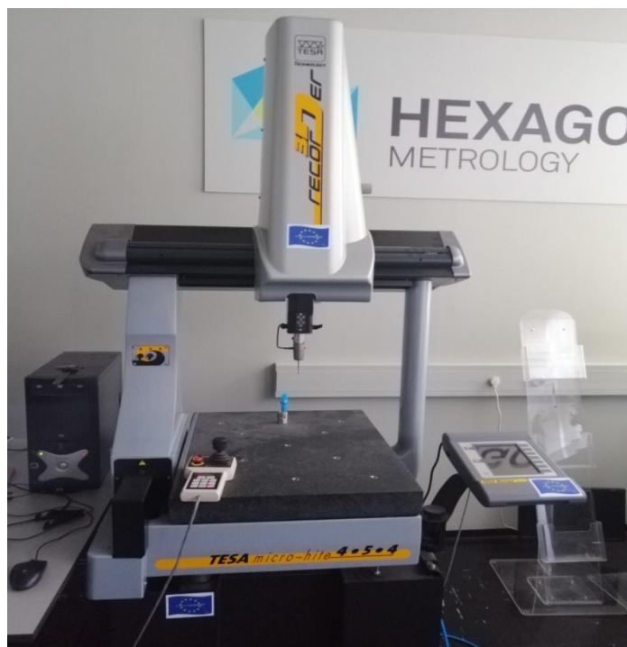
Слика 6.4 3D Машина TESA Micro-Hite 3D, уређај који се налази на Факултету инжењерских наука Универзитета у Крагујевцу
