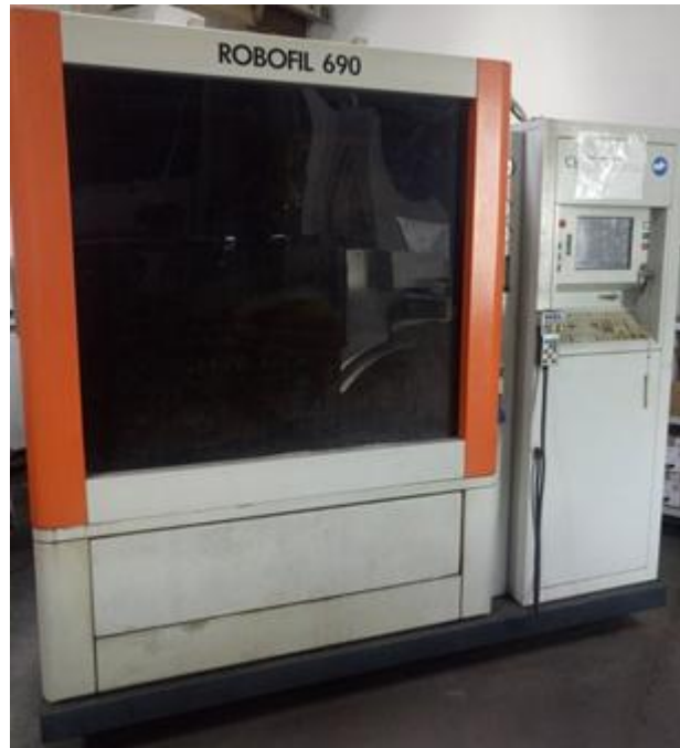
Слика 3.2 EDM сечење жицом ROBOFIL 690
