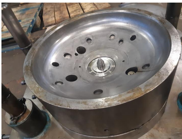
Слика 5.15 Алат за дубоко извлачење, представљен је горњи обликач
