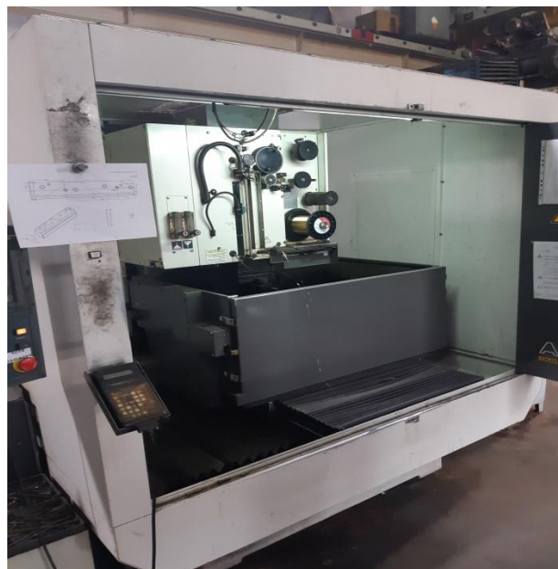
Слика 3.3 EDM машина CHARMILLES ROBOFIL 850
