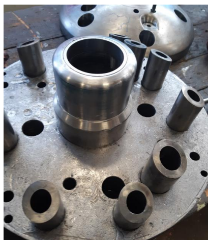
Слика 5.18 Положај обликача и ножева
