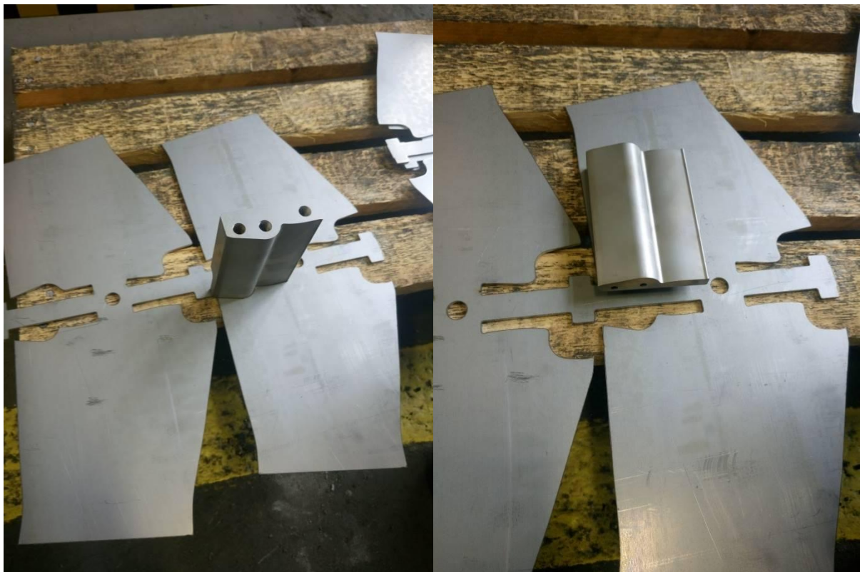
Слика 5.4 Приказан положај и улога ножа
