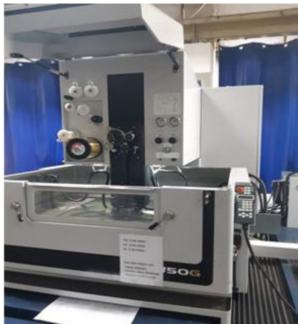
Слика 3.1 EDM сечење жицом Excetek V850G Ерозимат на којем је рађен експеримент
