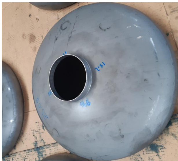
Слика 5.14 Пример врха бојлера који се добија дубоким извлачењем
