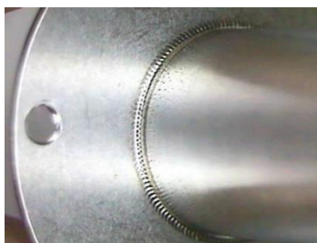
Слика 2.26. Изглед циркуларног ласерског заваривања [9]
