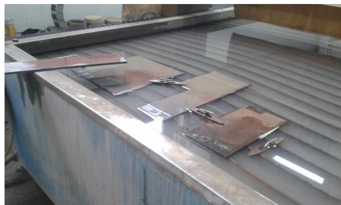
Слика 5.12. Позиционирање и причвршћивање делова на машини
