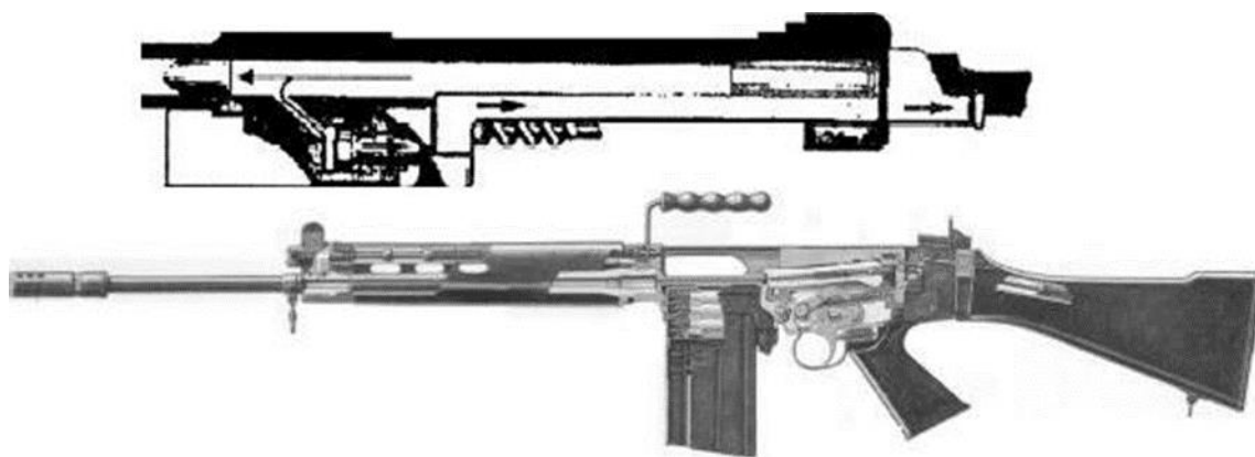
Слика 2.2.6 Позајмица барутних гасова са кратким трзањем клипа [3]
