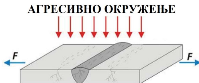
Слика 3.15 Чиниоци напонске корозије [16]
