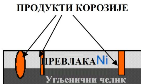
Слика 5.7 Катодна превлака никла на челику [39]
