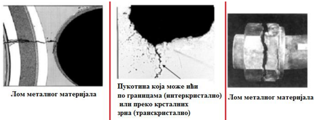
Слика 3.14 Примери ломова материјала услед напонске корозије [10]
