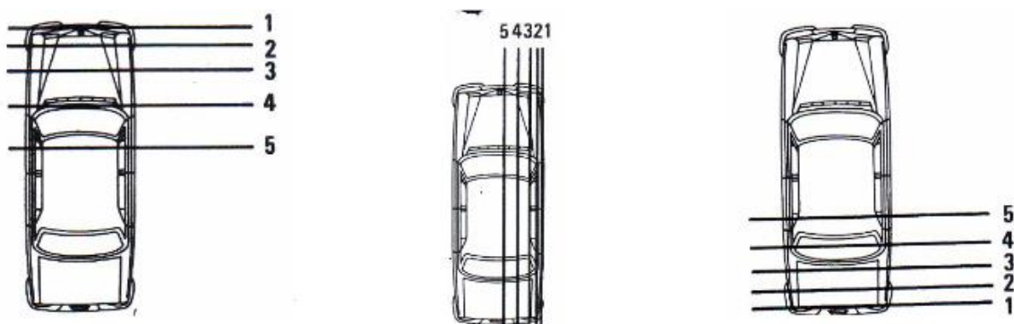
Слика 23. Степен оштећења
