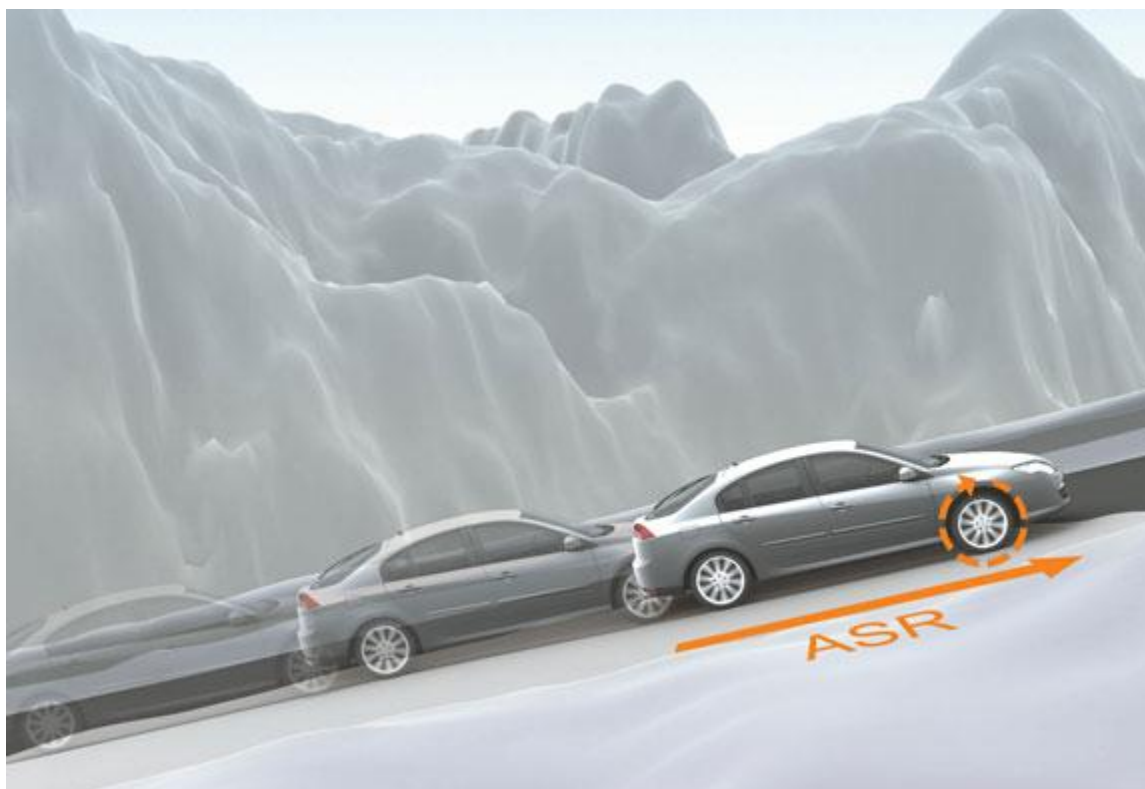
Слика 3 - ASR - Контрола проклизавања
