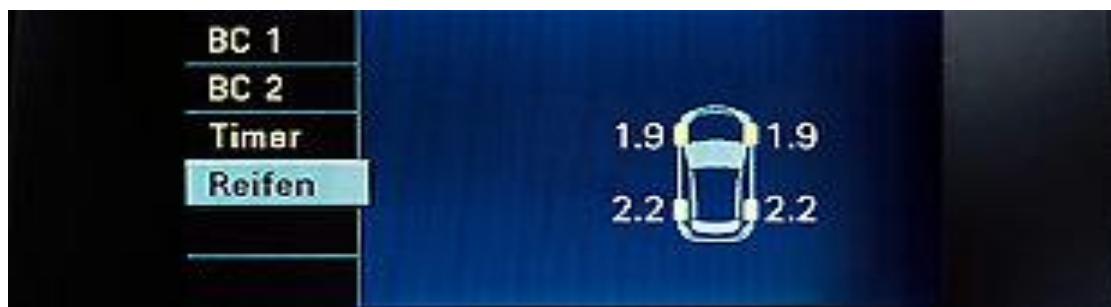
Слика 11 – Графички и инфо дисплеј система надзора притиска у гумама
