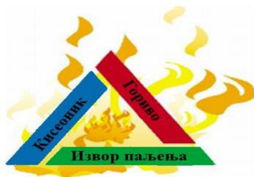
Слика 5. Настанак пожара при присуству три компоненте [1]
