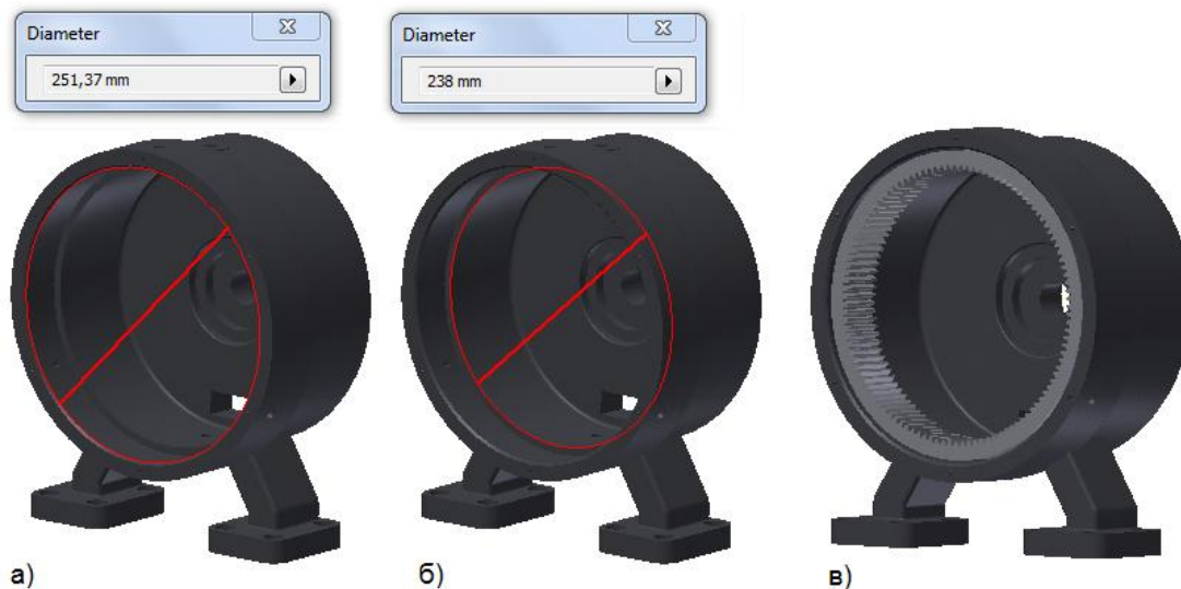
Слика 10.5 а) Пречник за постављање зупчаника са унутрашњим озубљењем; б) пречник граничника; в) приказ монтираног зупчаника са унутрашњим озубљењем
