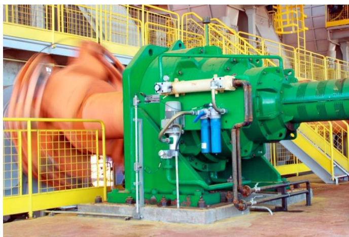
Слика 9.6 Један од највећих планетарних преносника на свету [10]
