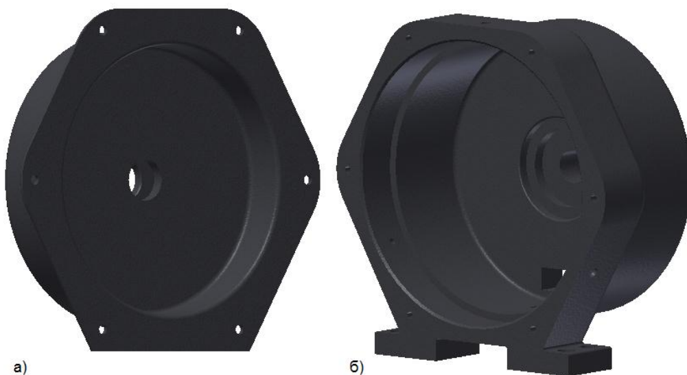
Слика 11.21 Унутрашњи изглед шестоугаоног кућишта
