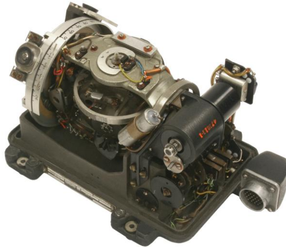
Слика 2.5 Model number: JG7044N Spinning Mass Vertical Gyroscope из 1950's
