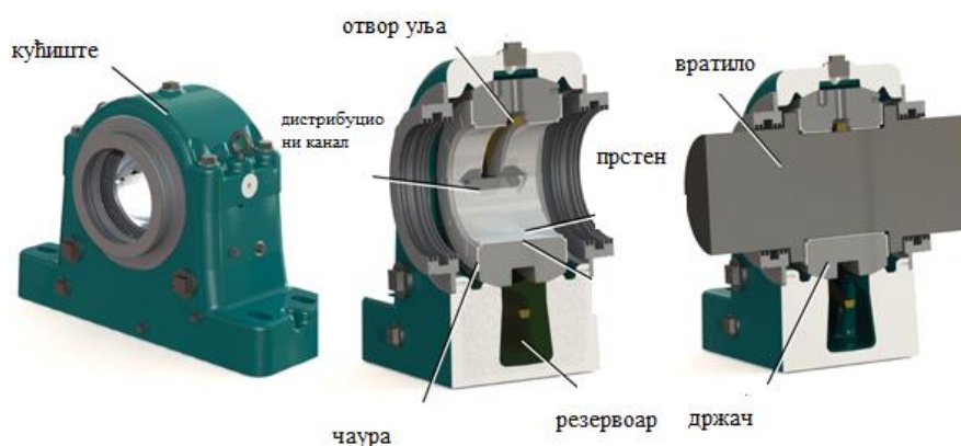
Слика 2.27 Подмазивање помоћу прстена
