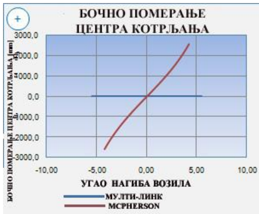
Слика 63: Приказ бочног померања центра котрљања у зависности од промене угла нагиба возила
