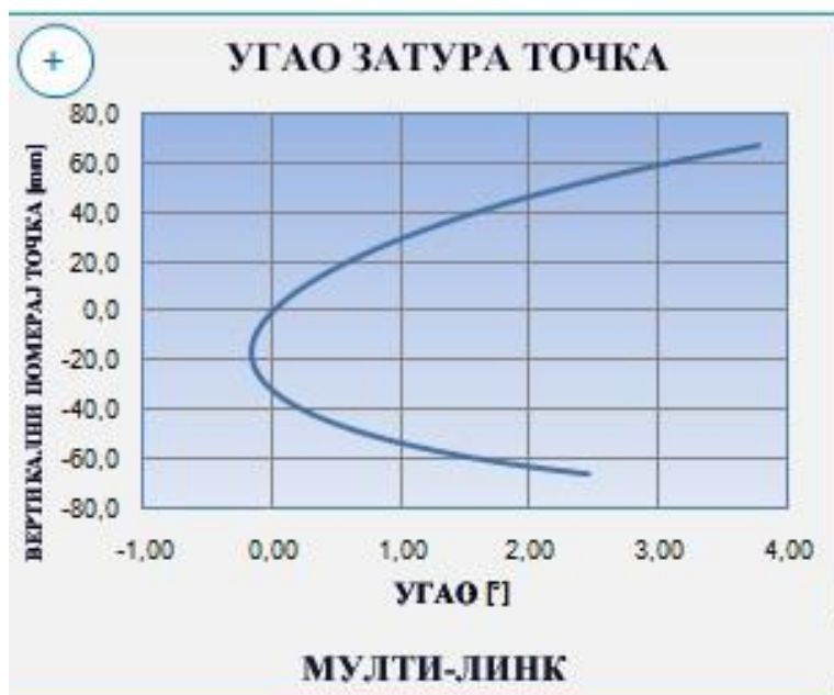
Слика 55: Угао затура точка код мулти-линк система ослањања
