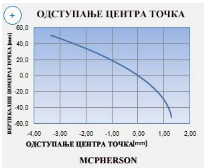
Слика 60: Одступање центра точка код McPherson система ослањања
