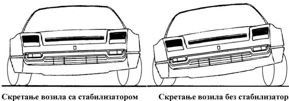
Слика 20: Илустрација понашања возила приликом промене правца (са стабилизатором и без стабилизатора)[20]
