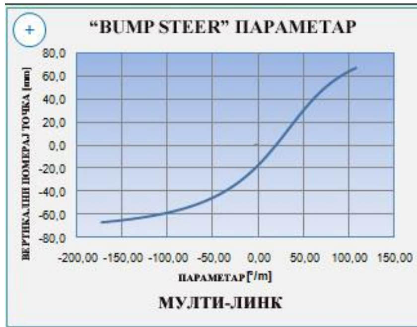
Слика 64: Утицај преласка возила са мулти-линк ослањањем преко неравнина на вредност „bump steer“ параметра
