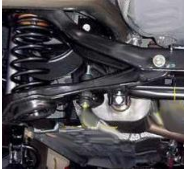
Слика 35: Приказ ослањања задње осовине возила Ford Focus[31]
