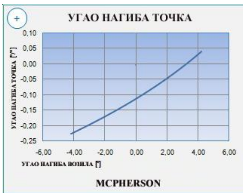
Слика 67: Утицај промене угла нагиба возила на угао нагиба точка (McPherson систем ослањања)
