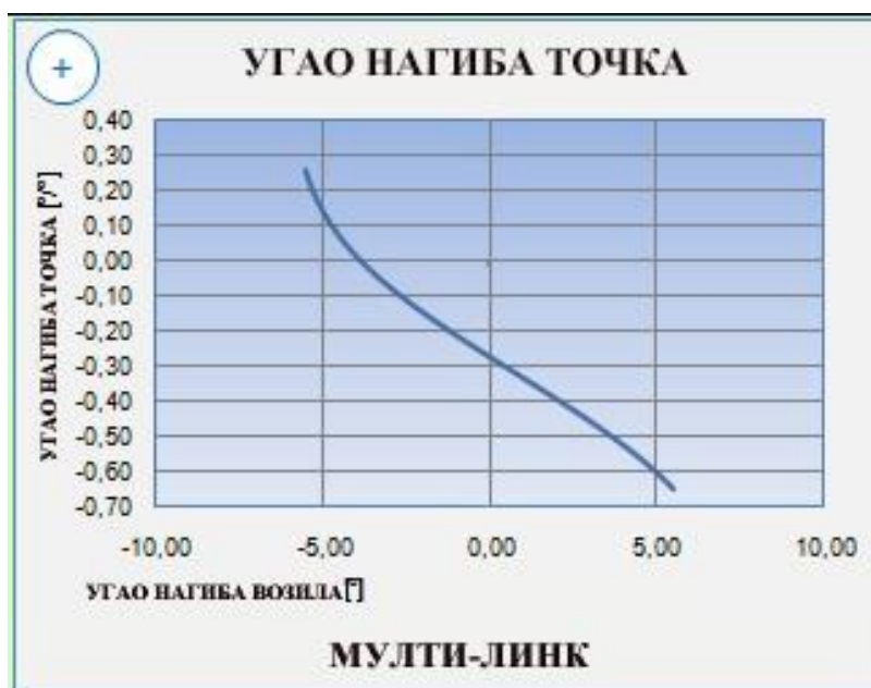
Слика 66: Утицај промене угла нагиба возила на угао нагиба точка (мулти-линк систем ослањања)
