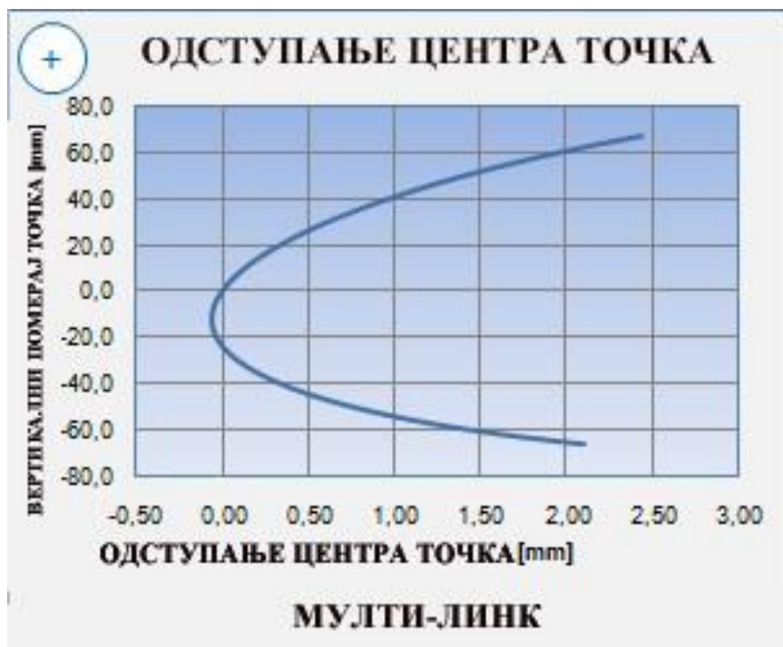
Слика 59: Одступање центра точка код мулти-линк система ослањања
