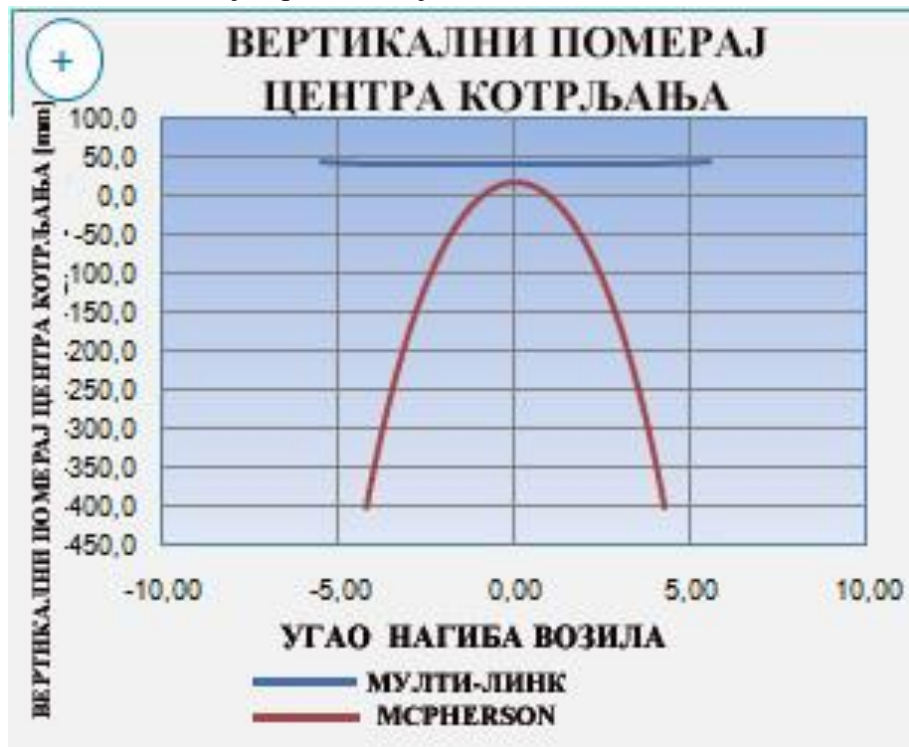
Слика 61: Приказ вертикалног померања центра котрљања у зависности од промене угла нагиба возила
