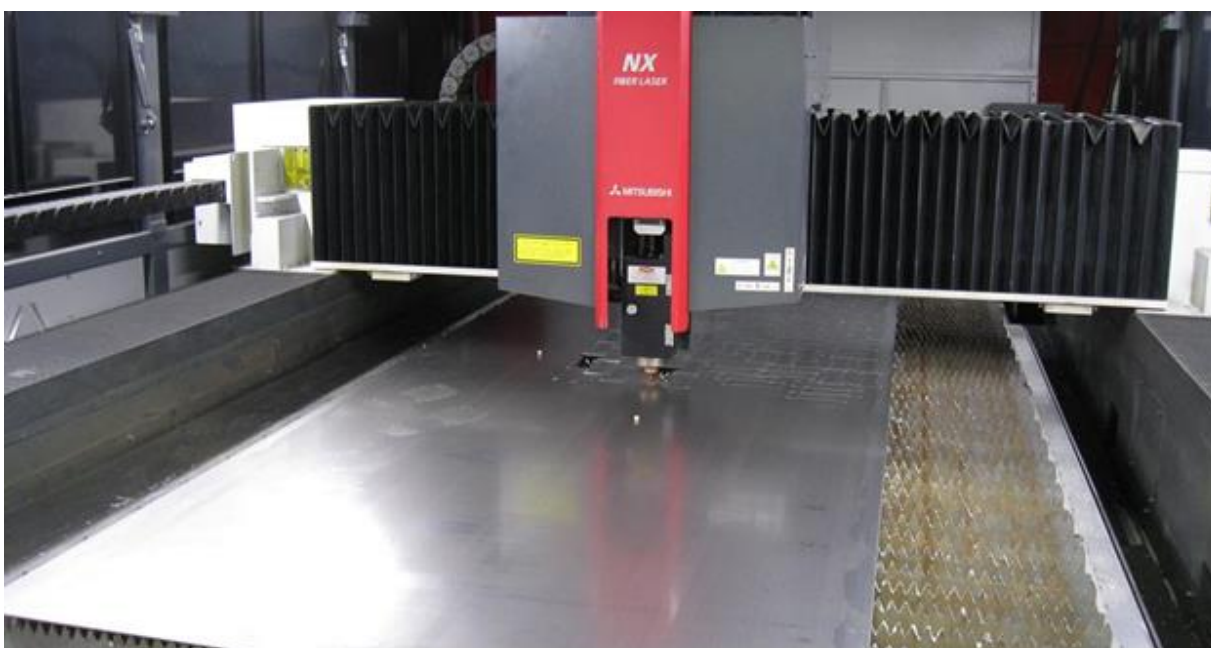
Слика 2.13 Приказ ласерског уређаја за сечење са „фибер“ ласером
