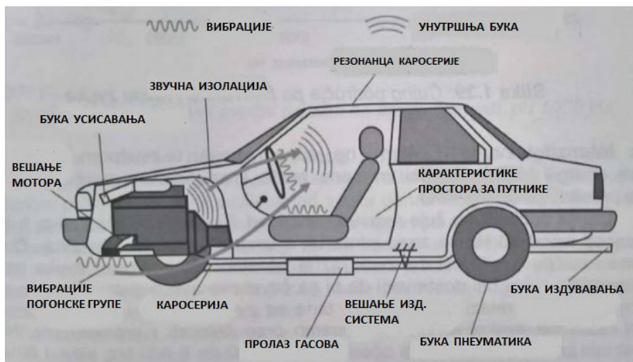
Слика 2.5: Извори буке и вибрација на возилу [4]
