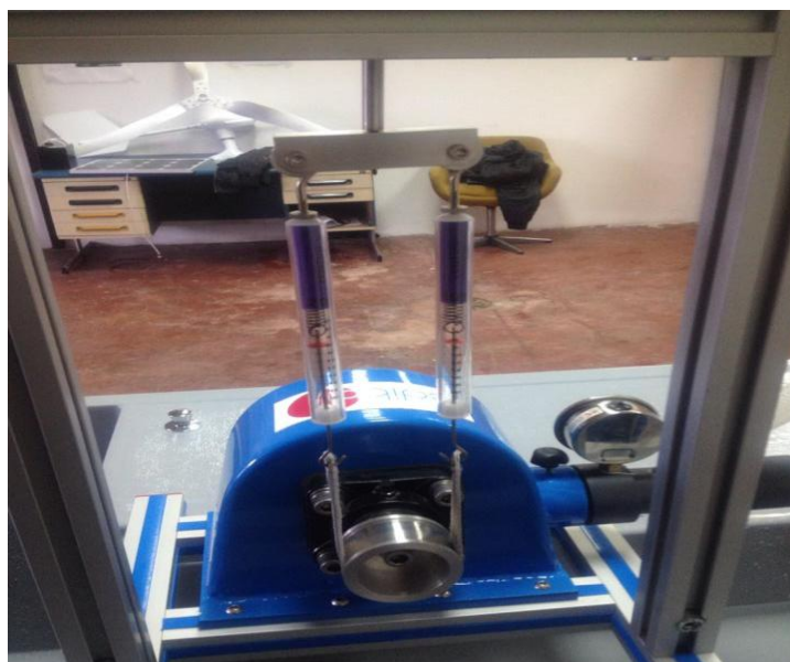
Слика 6.3 Механичка кочница са два динамометра
