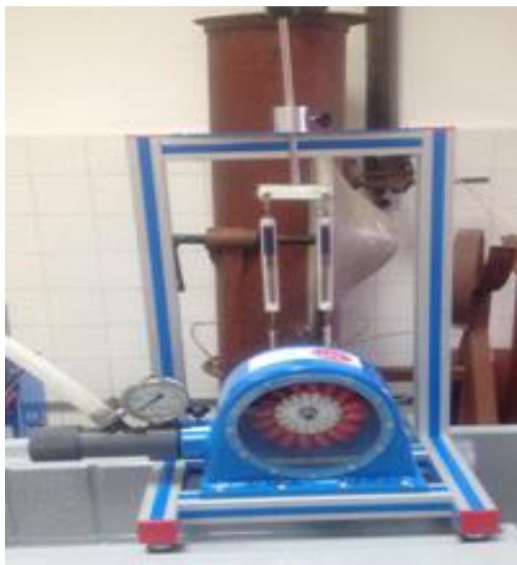
Слика 6.1 Пелтонова турбина (на којој су вршени експерименти)
