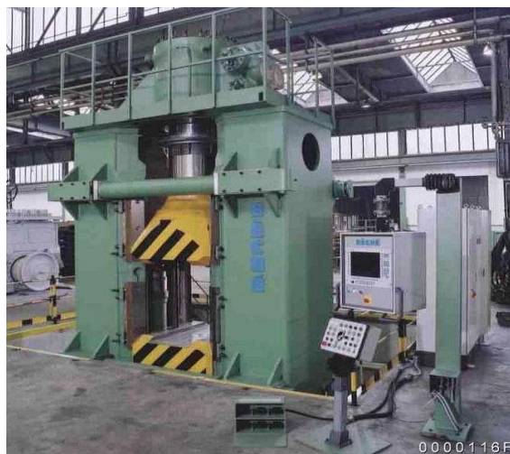
Слика 12. Противударни чекић фирме Bache [10]
