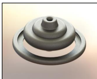
Слика 21. Пример постављања равни која на начин који обезбеђује једноставан алат за уклањање венца, са 3D отковком и исеченим венцем
