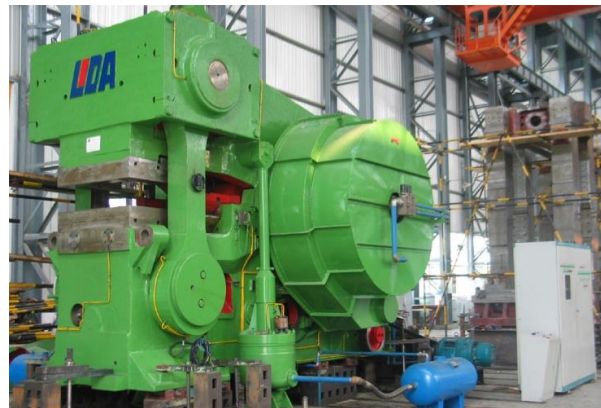
Слика 16. Шема хоризонталне ковачке машине (1-сабијач, 2- непокретни део матрице, 3-покретни део матрице [3]) са спољашњим изгледом[11].
