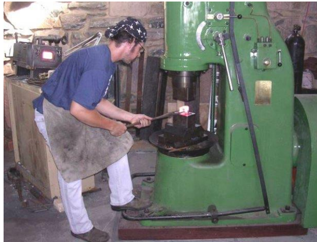
Слика 1. Слободно ковање пнеуматским чекићем
