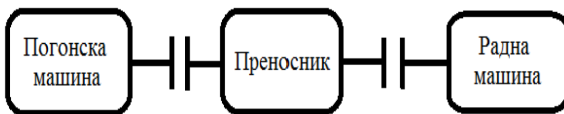
Сл. 4 – Шема постављања механичког преносника
