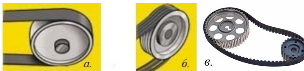
Сл. 6 – а. Пљоснати каиш, б. Трапезни каиш, в. Зупчасти каиш [6]
