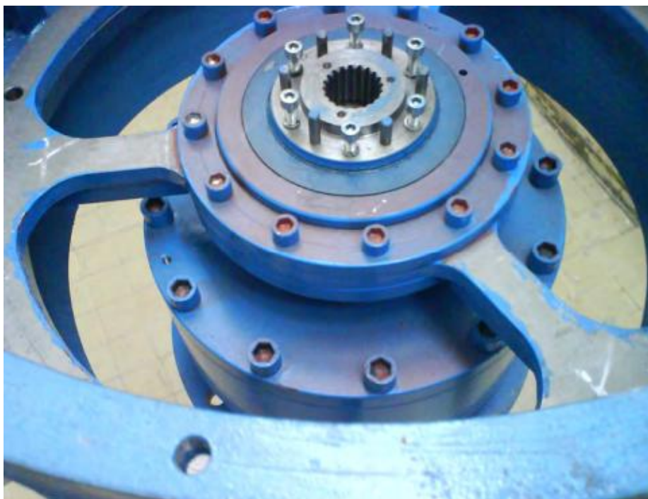
Слика 33. Планетни преносник уграђен у базни подсклоп машина [36]
