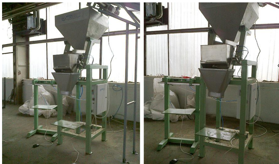
Слика 18. Постојење за паковање пелета од 15kg у PVC вреће 26
