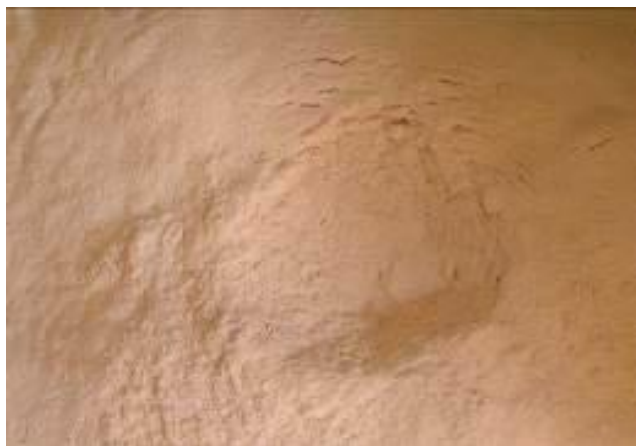
Слика 13. Изглед припремљене сировине(дрвено брашно)
