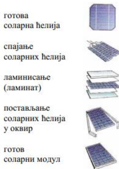
Слика 22. Поступак монтаже PV ћелија у PV модул [7]
