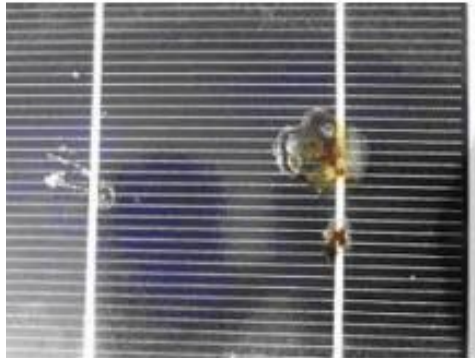
Слика 19. Оштећење PV модула услед појаве „ Hot Spota “[15]
