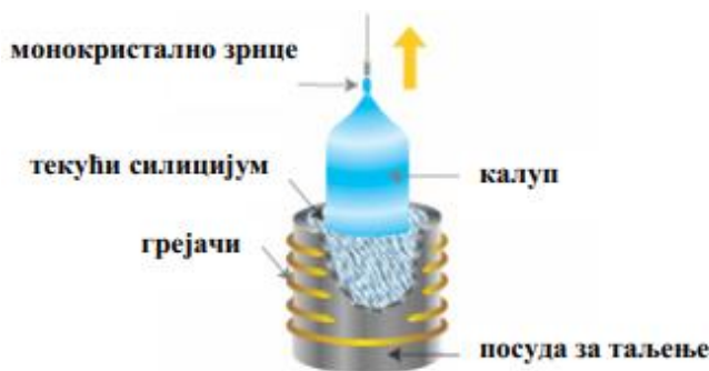
Слика 7. Уређај за добијање монокристалног Си методом Czochralski [6]
