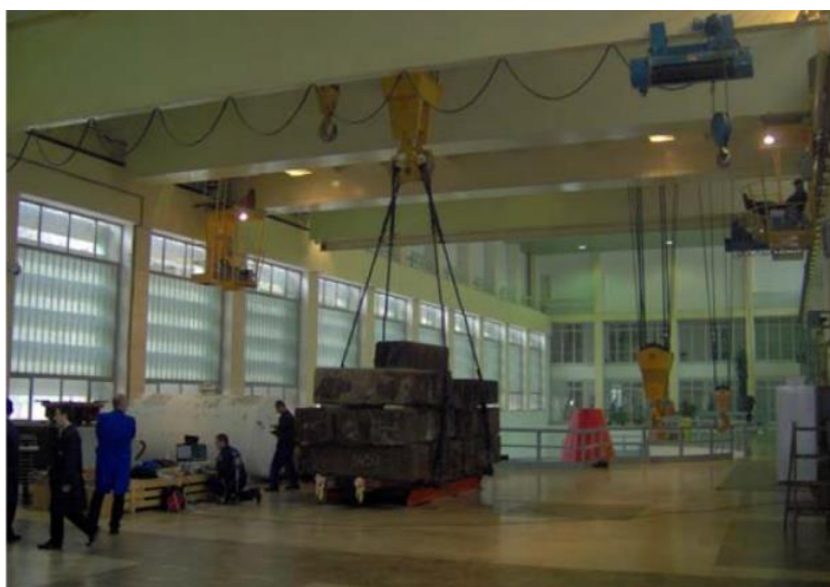
Слика 39: Испитивање дизалице пробним теретом [12]
