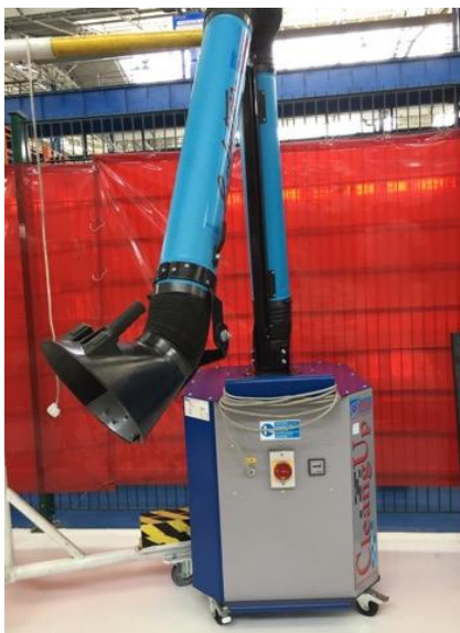
Слика 3.7 - Покретни вентилатор за усисавање дима
