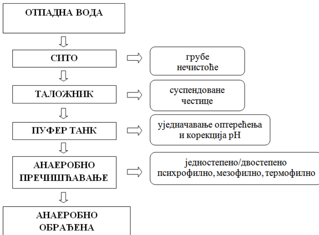
Слика 17. Шема анаеробног пречишћавања отпадних вода у млекарској индустрији [1]
