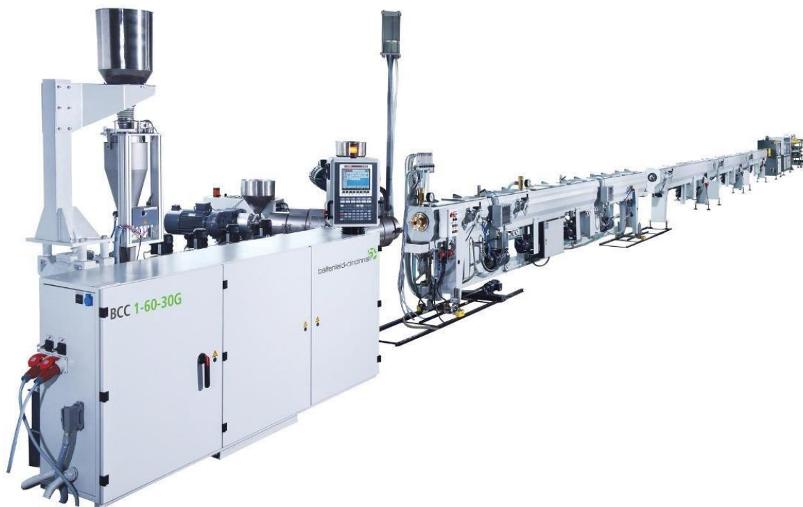
Слика 8. – Линија за екструдирање трослојне цеви, battenfeld-cincinnati [5]
