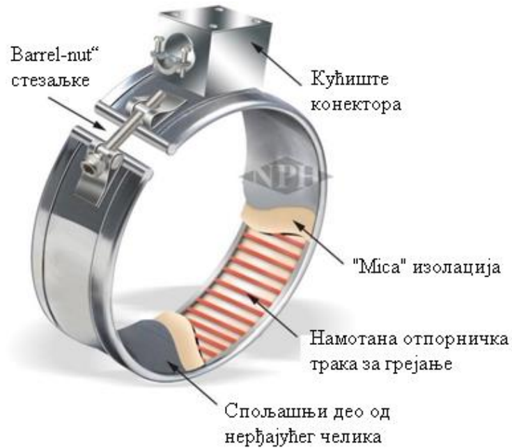
Слика 23. – Прстенасти грејач изплован „миса“ материјалом [9]
