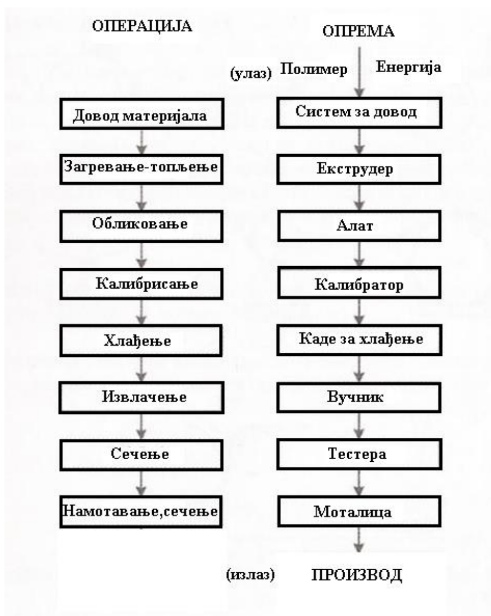
Слика 7. – Шематски приказ операција и опреме линија за екструдирање [4]
