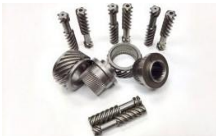
Слика 30. T2P Торзен диференцијал [15]
