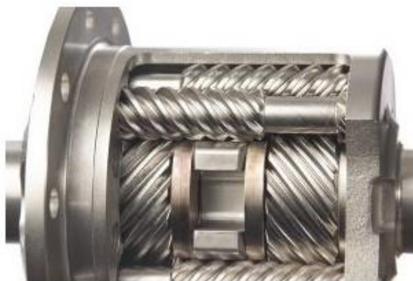
Слика 29. T2 Торзен диференцијал [15]
