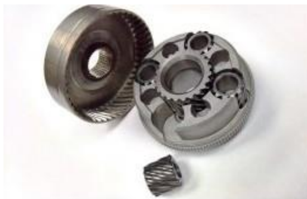
Слика 31. Т3 Торзен диференцијал [15]
