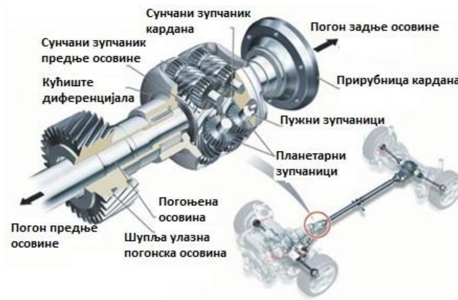
Слика 11. Међуосовински диференцијал Торзен примењен на моделу Audi A4 quattro [8]
