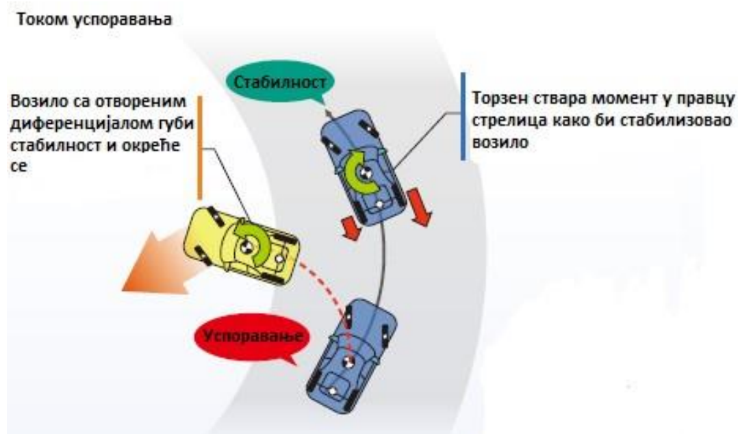
Слика 33. Понашање Торзен диференцијала у кривини током успоравања [17]
