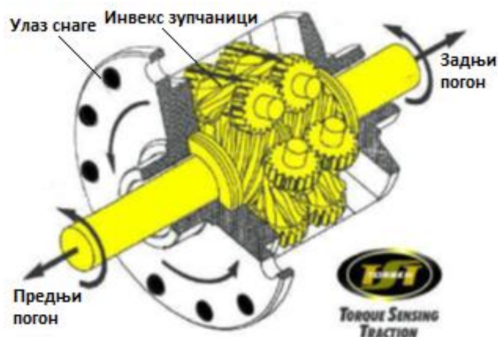
Слика 18. Торзен диференцијал [6]
