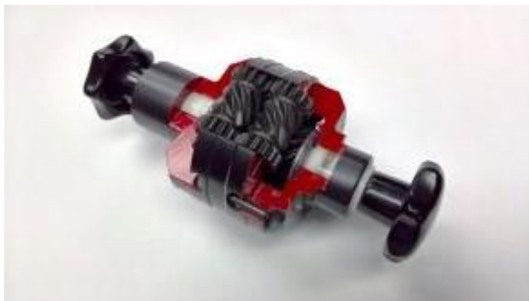
Слика 28. Т1 Торзен диференцијал [15]
