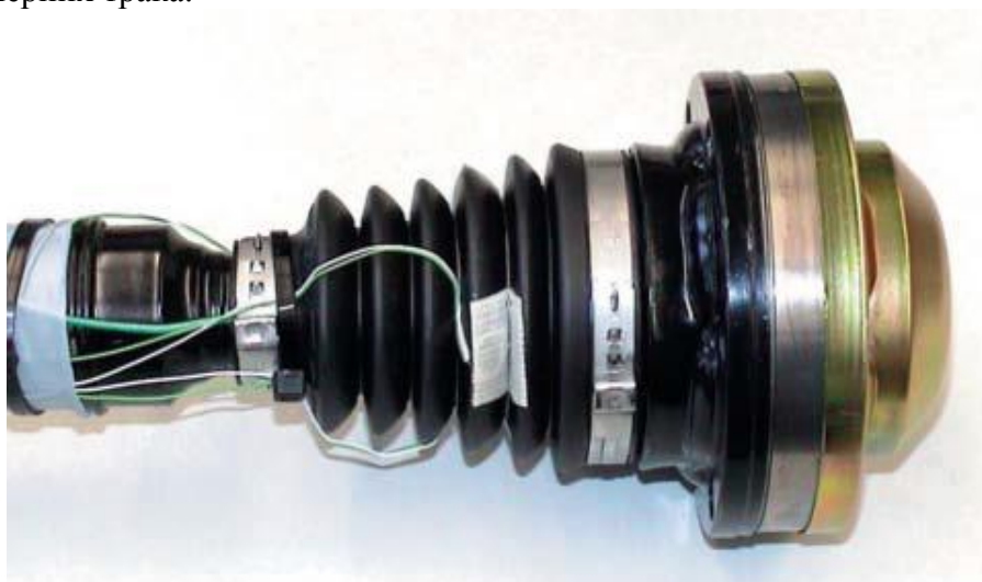
Слика 36. Залепљени термопарови на погонском вратилу возила[6]
