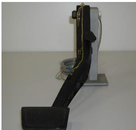
Слика 28. Мерење напрезања на педали возила [8]
