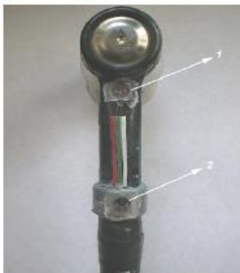
Слика 29. Постављање розета на спони: 1- активна розета, 2- компензациона розета [1]
