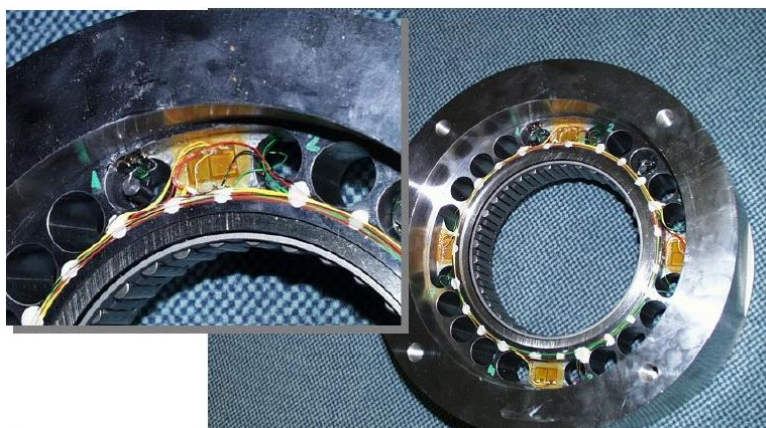
Слика 27. Мерење силе улежиштења код котрљајног лежаја [9]
