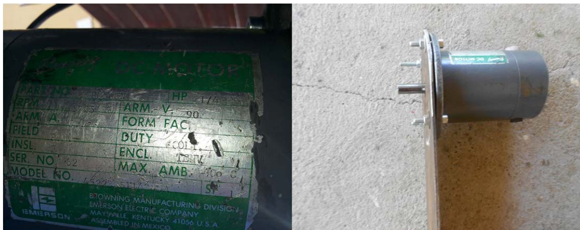
Слика 8: Електромотор/генератор Emerson DC motor 3
