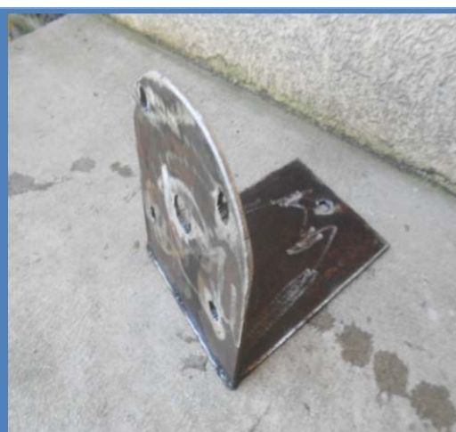
Табела 5: 2D и 3D приказ држача мотора и приказ његових карактеристика 4
