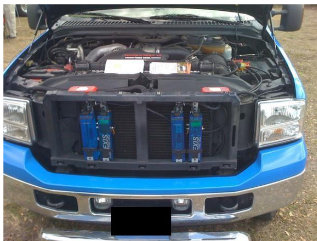
Слика 17. Позиционирање ННО генератора
