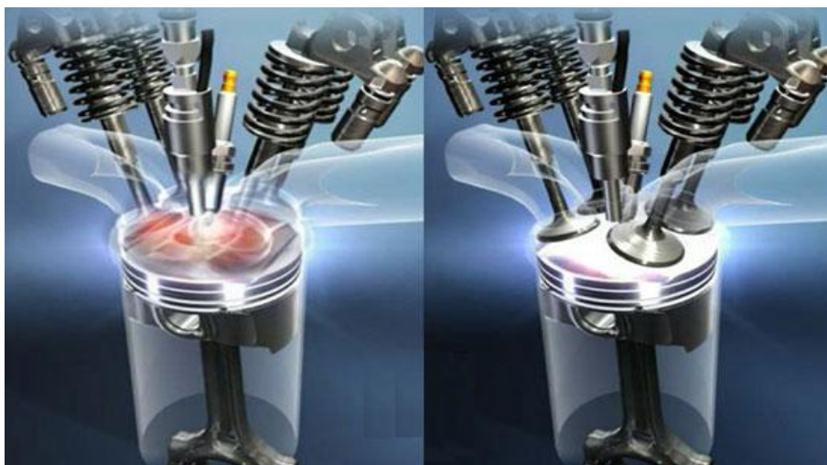
Слика 25. Илустровани приказ сагоревања смеше у цилиндру 19
