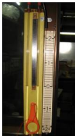
Слика 12. Мерило диференцијалног притиска [6]
