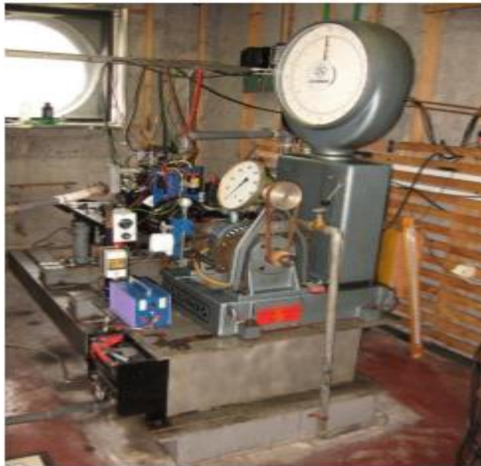
Слика 6. Моторска кочница SCHENCK U1- 16h
