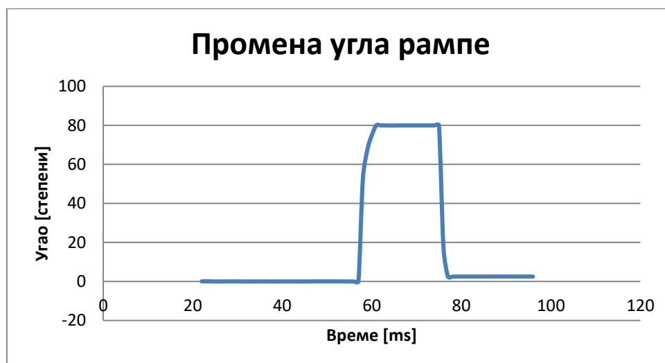
Слика 8.6. Апериодични одзив угла рампе
