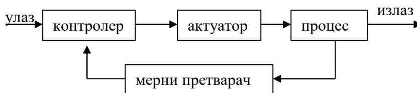
Слика 5.1.1. Актуатор у систему управљања са повратном спрегом [9]
