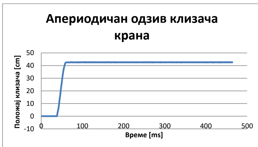
Слика 8.3. Аперіодичан одзив клизача крана, K=-0.25
