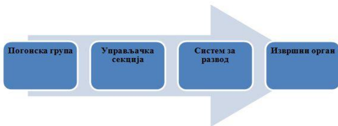
Слика 6. Блок дијаграм хидрауличног система
