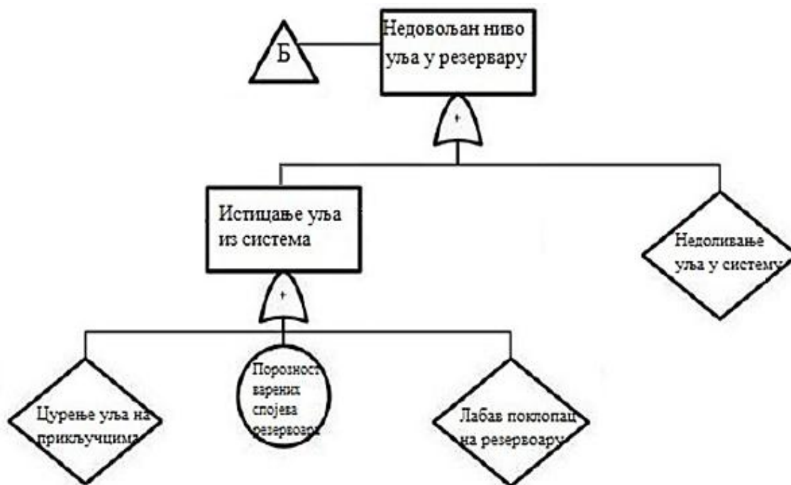
Слика 26. Независно подстабло отказа за вршни догађај „Недовољан ниво уља у резервару”
