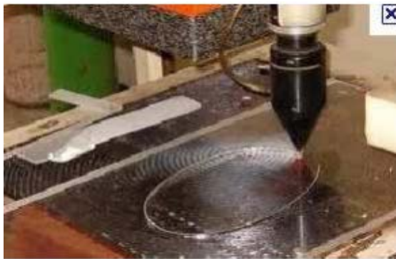
Слика 15. Приказ обраде сечења ласером (лим и дрво) [ 5]
