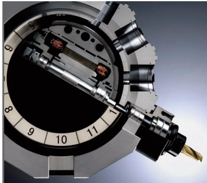
Слика 3.16. BMT револверска глава са брзоизменљивим начином стезања [7]
