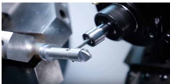
Слика 3.13. Радијално бушење помоћу револвер главе
