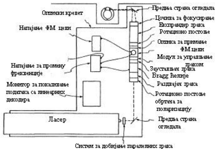
Слика 4.13 - Ласер и пратећа опрема инсталирана на столу [3]
