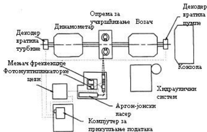
Слика 4.11 - Шема експерименталног апарата [3]
