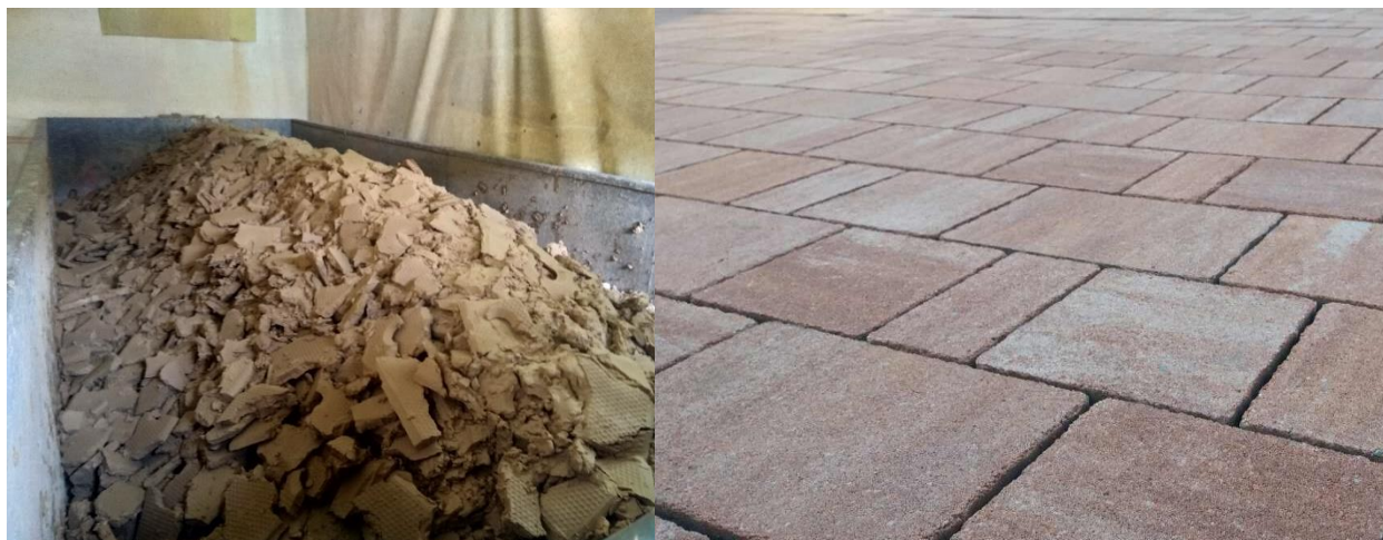
Слика 51. Филтер погача и могућност њеног коришћења
