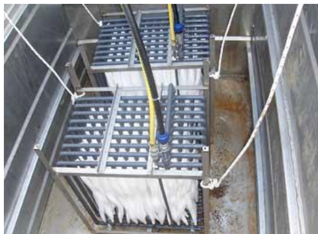
Слика 15. Унутар-реакторска конфигурација мембранског биореактора
