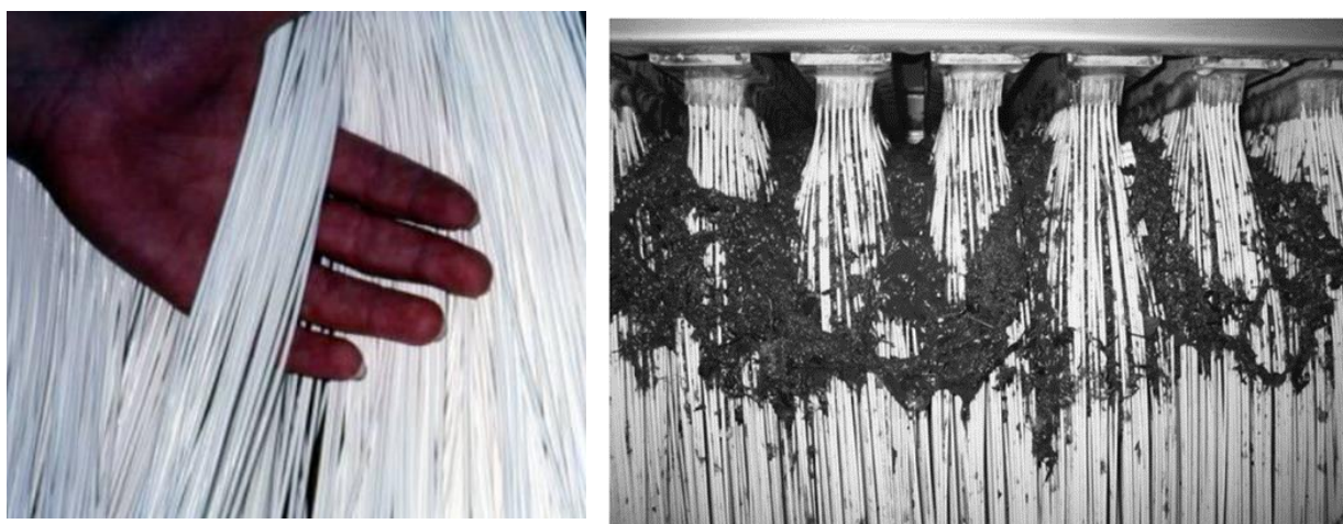
Слика 17. Пример задржавања нечистоћа на мембрани
