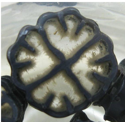
Слика 21. Задржавање микрофлоре на носачима
