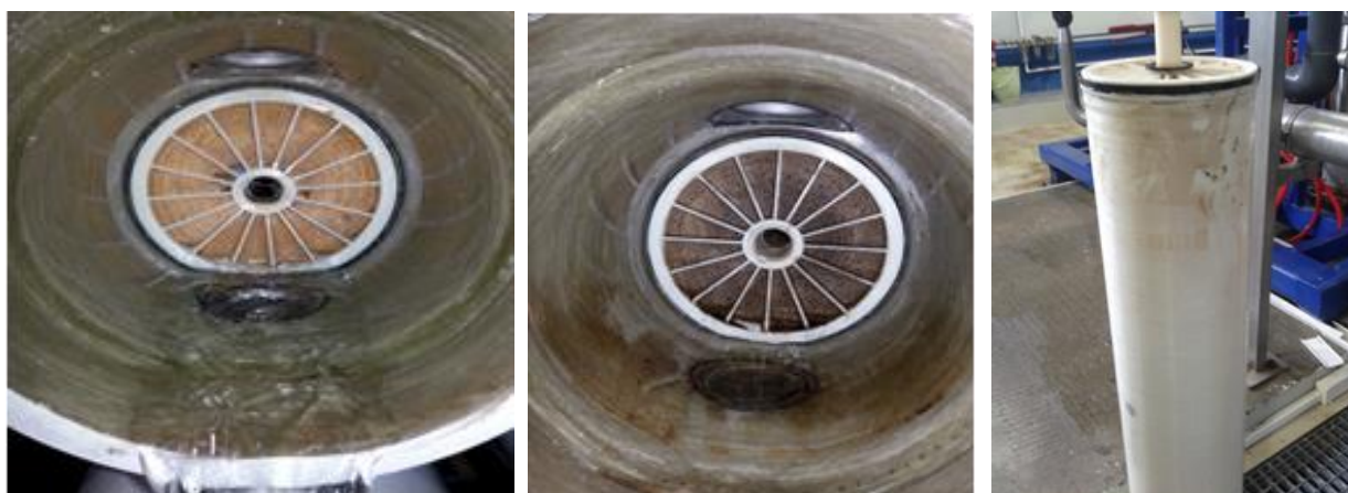
Слика 25. Приказ нове и истрошене мембране
