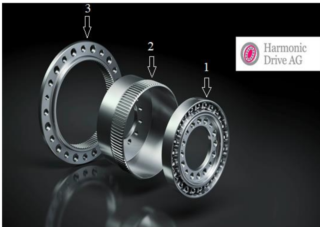
Слика 1. Расклопљен таласни преносник (1-генератор таласа, 2-еластични зупчаник, 3-чврсти зупчаник)
