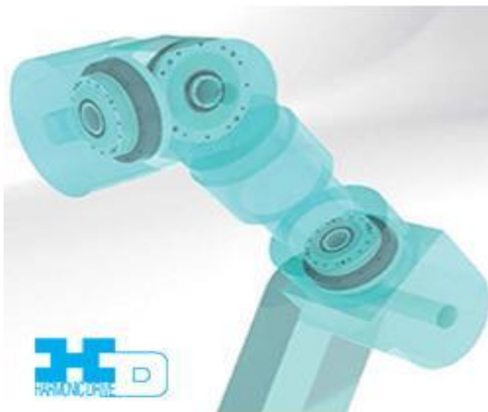
Слика 19. Примена таласног преносника као саставног дела роботске руке
