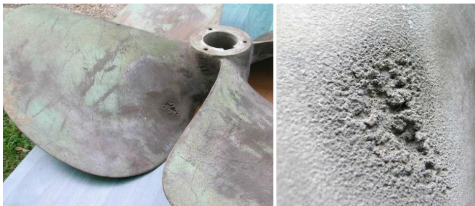
Слика 2.17 Кавитациона корозија лопатице бродске елисе
