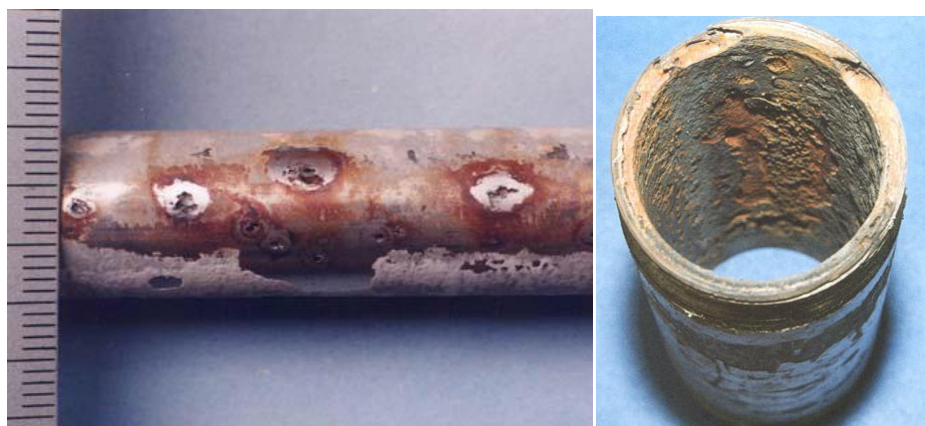
Слике 2.14 Приказ примера питинг нерђајућег челика изложеног агресивној корозионој средини
