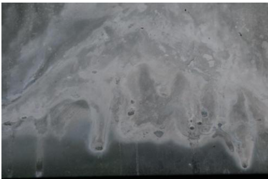
Слика 3.2 Корозија стакла
