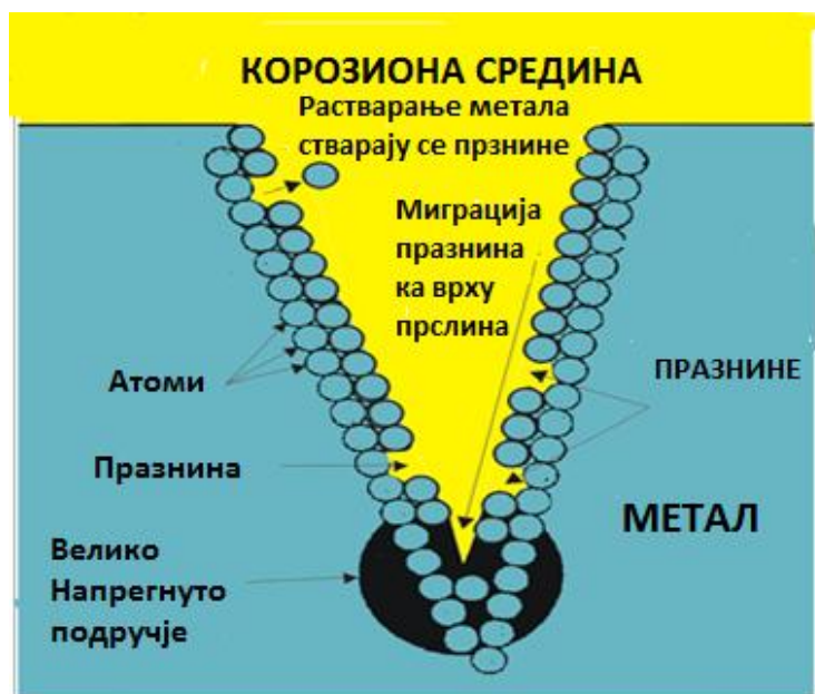
Слика 2.5 Шематски приказ механизма разарања метала потпомогнутог механичким дејством
