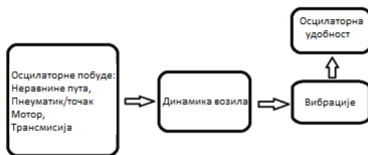
Слика 1 - Утицај осцилаторних побуда на возило и човека [3]
