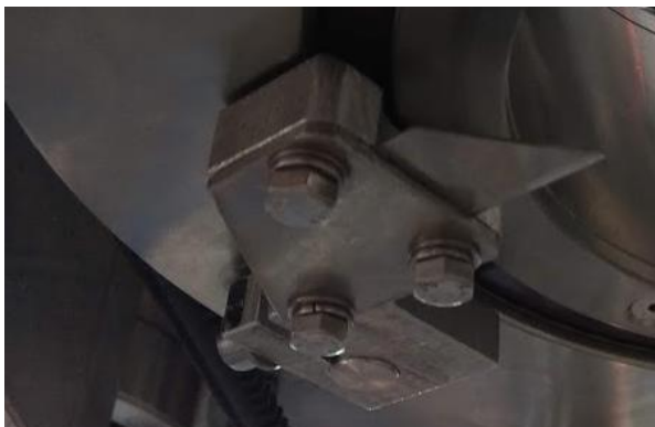
Слика 30. Носач ножа: а) 3D модел б) фотографија реалног дела
