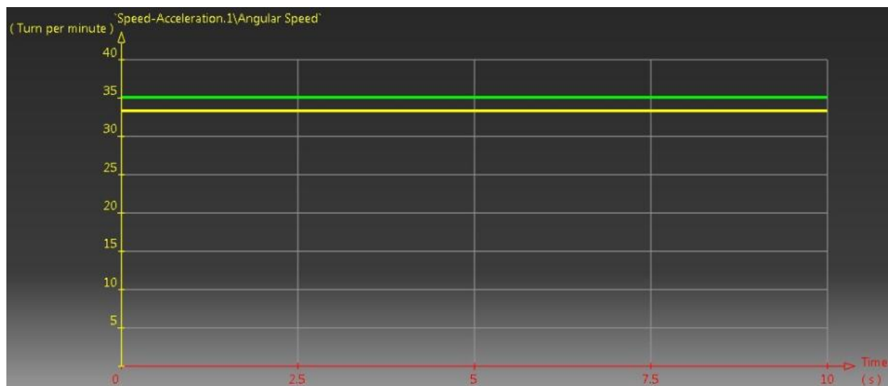
График 1. Зависност угаоне брзине пужа од времена (жута линија)
