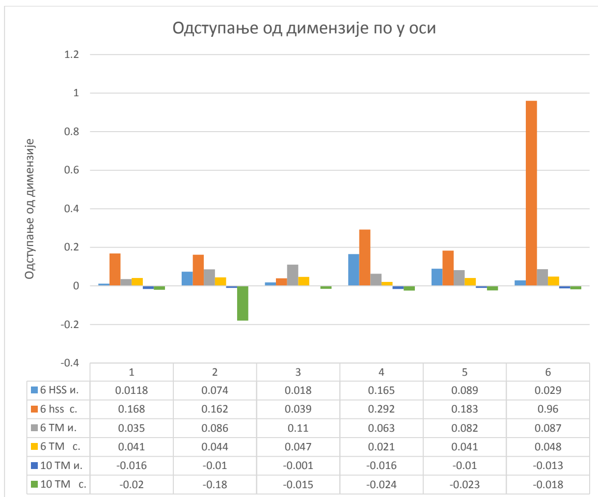
Слика 4.60 Одступање од димензије по у оси
