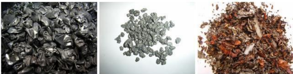
Слика 15. Фракције материјала које садрже метал након дробљења и одвајања материјала (с лева на десно: фракција гвожђа-никла, фракција алуминијума, фракција фолије електроде).
