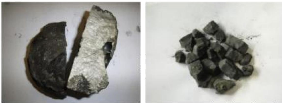
Слика 17. Метална легура (лево) и шљака (десно) произведени су у лабораторијским тестовима
