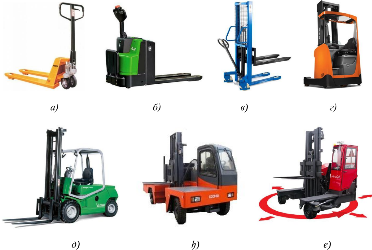
Слика 6. Врсте виљушкара: а) Ручна палетна колица, б) Електрична палетна колица, в) Ручни високоподизни виљушкар, г) Високоподизни виљушкар са седиштем за возача, д) Чеони виљушкар, ђ) Бочни виљушкар и е) Четворостепени виљушкар [7].
