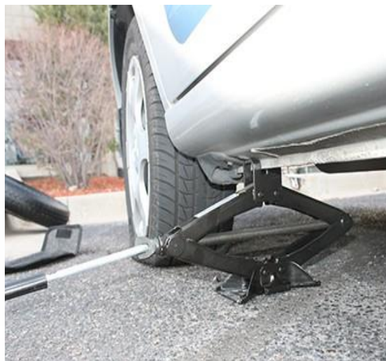
Слика 2. Ручна дизалица са навојним вретеном и њена примена [2]
