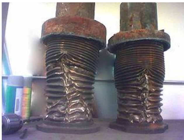
Слика 12 – Експанзионни спојевци уништени услед хидрауличног удара [12]
