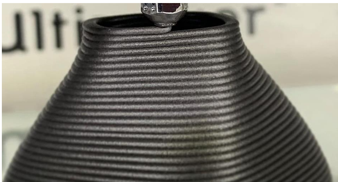
Слика 11 Увећани приказ наношење слоја филамента висине 0.1 mm [21]
