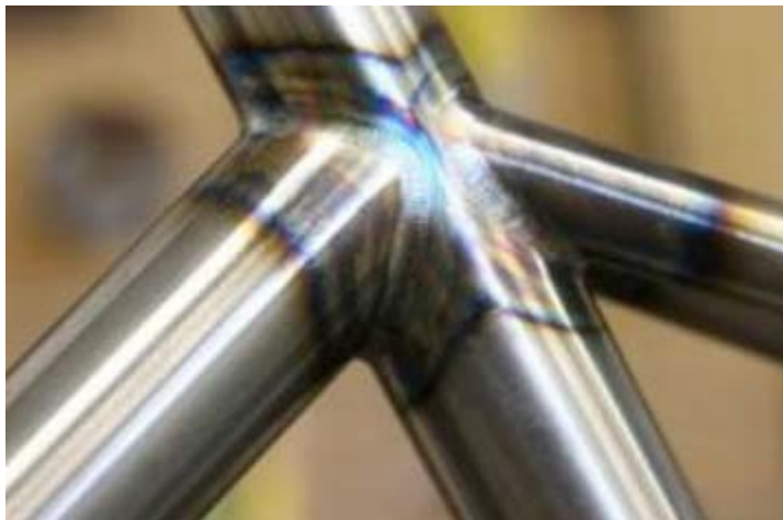
Слика 1.6 – Заваривање штапова
