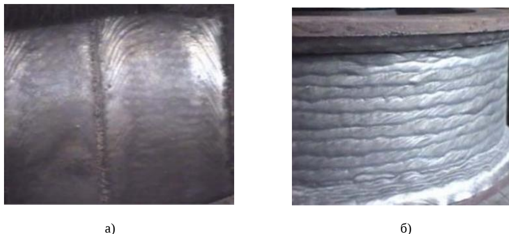
Слика 7.20 а) изглед широког навара (60 mm) изведеног са осцилаторним кретањем, б) изглед уског навара изведеног са спиралним кретањем [18]
