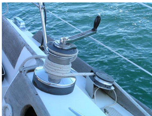
Слика 3.5 Примена витла код једрилице за дизање једра
