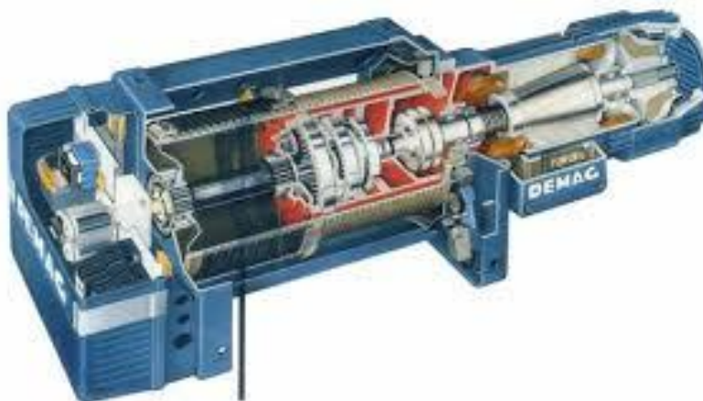
Слика 5.11 Двобрзинско електрично витло типа „Demag” [16]
