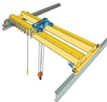
Слика 5.8 Стојеће покретно витло [15]
