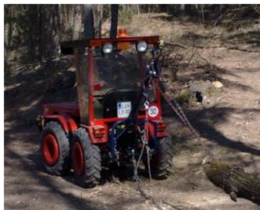
Слика 3.3 Примена витла код трактора за вучу дрва
