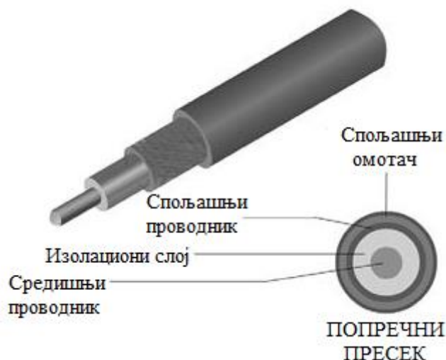
Слика 6.3 Коаксијални кабл [17]
