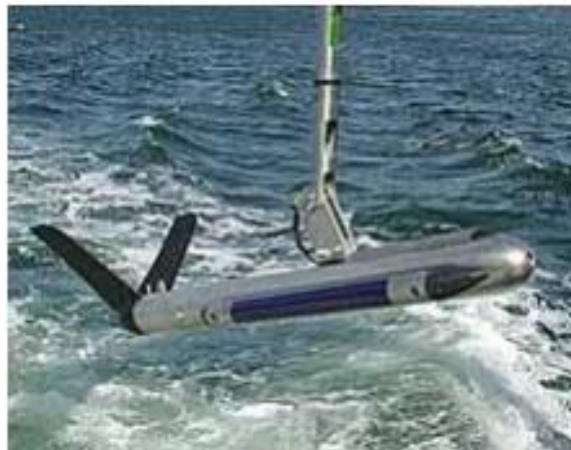
Слика 4.2 Side scan sonar [6]
