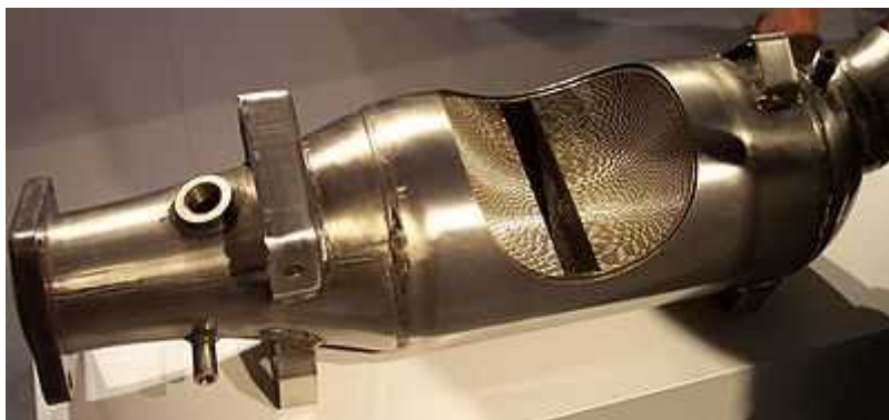
Слика 4.2 Пресек каталитичког претварача
